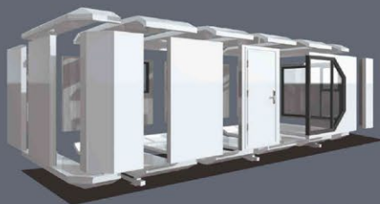
Superficie construida: 22.6 m 2 (Tipo desmontado en contenedor de 40 pies) SA30 Largo: 6500 mm Ancho: 3480 mm Altura: 3300 mm
