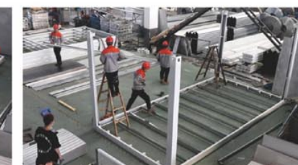
3 Instalar las columnas y asegurarse de que estén verticales
